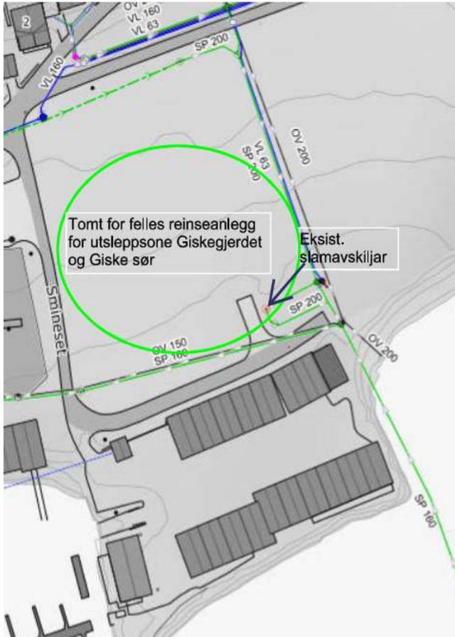
Figur 47: Eksisterende og planlagt utviding slamavskiljar 70 Giske sør
