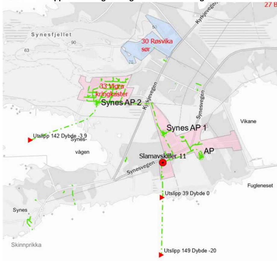
Figur 33: Utsleppssone 33 Vigra kringkaster. Eksisterande avløpsanlegg til utlepp 149
