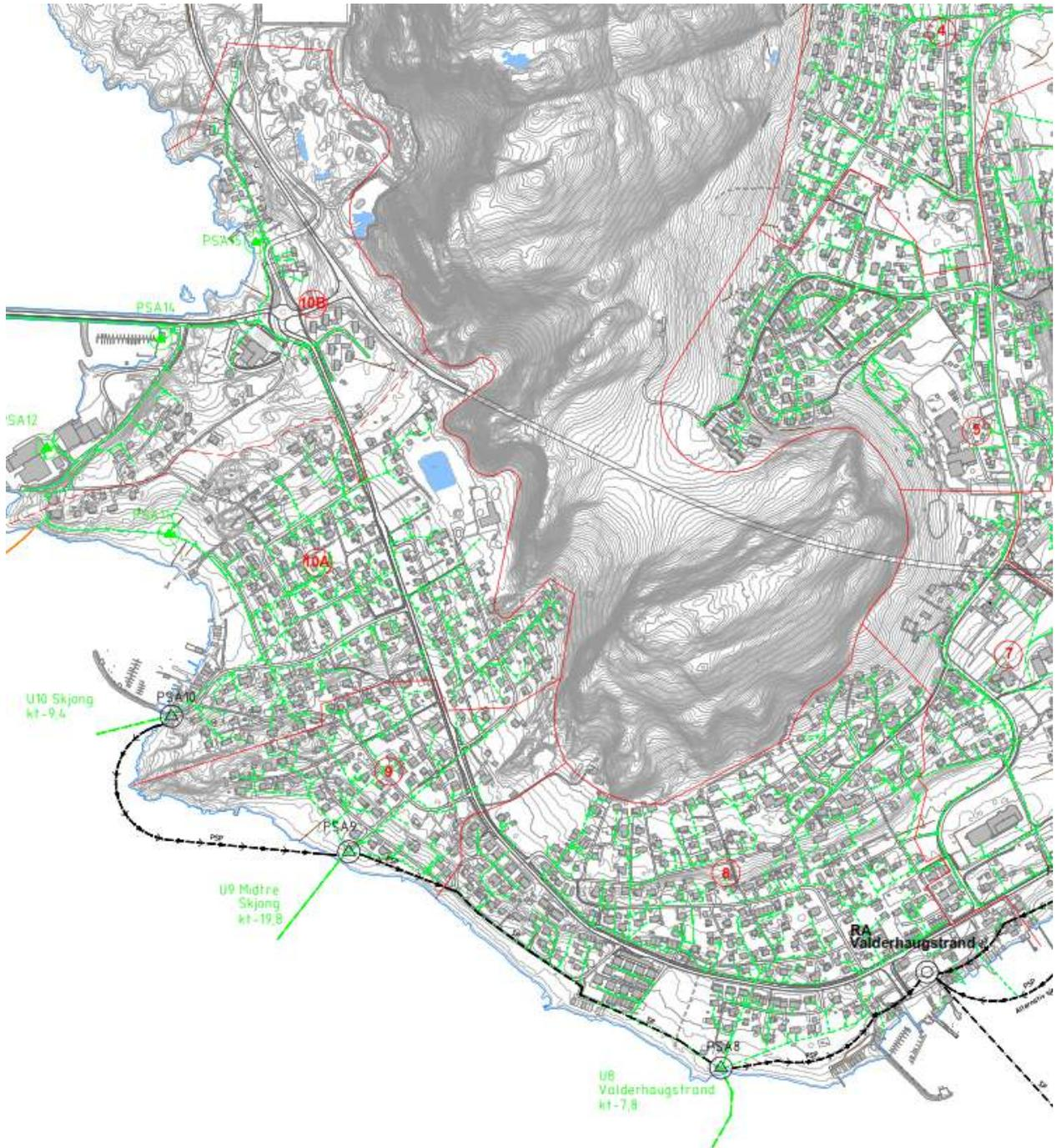
Figur 69: Planlagt overføring av avløp fra utsleppsone 10A, 10B og 9 til planlagt reinseanlegg RA Valderhaugstrand - alternativ 3A
