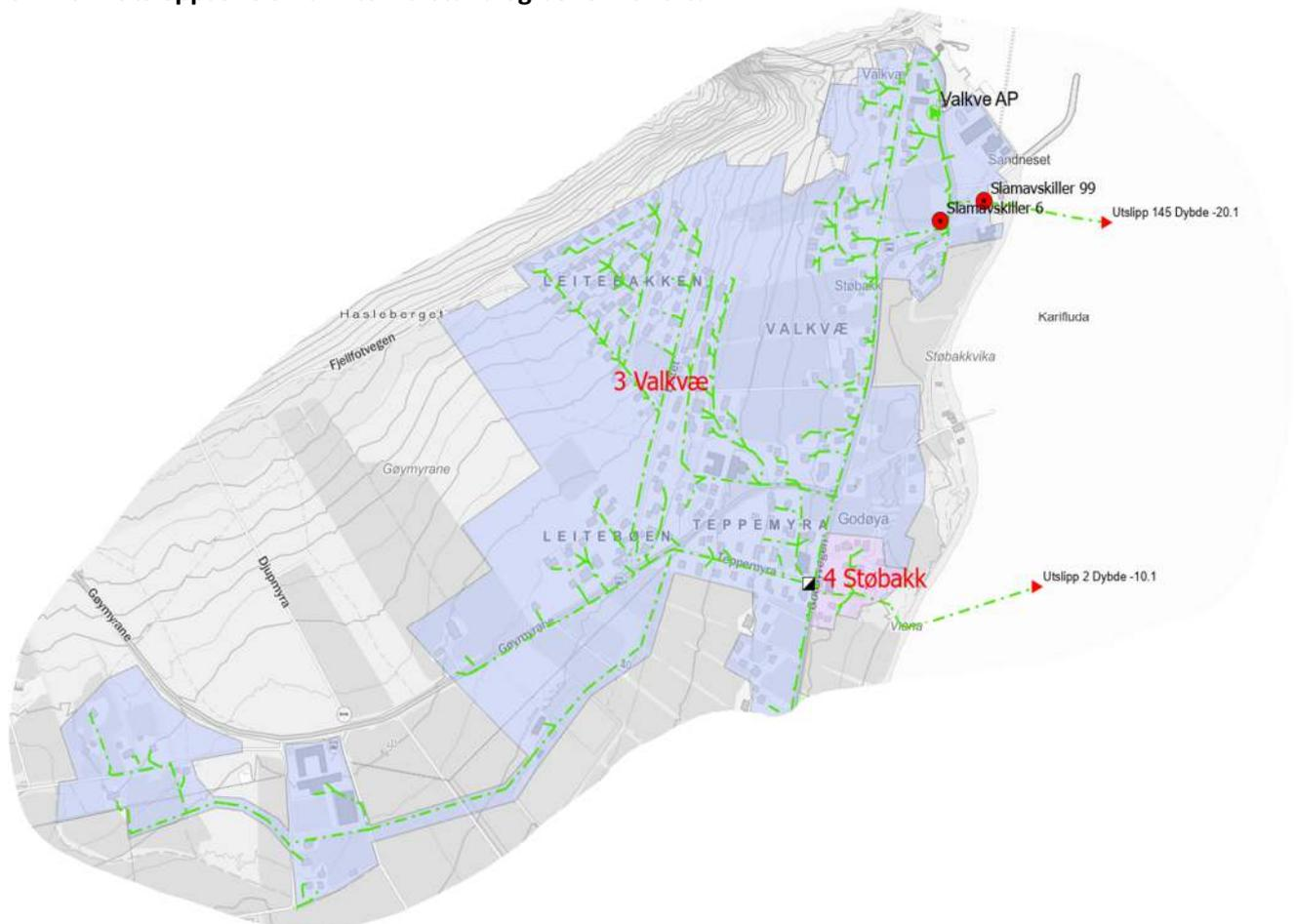
Figur 53: Utsleppsone 3 Valkvæ – Eksisterende avløpsanlegg til utsepp 145
