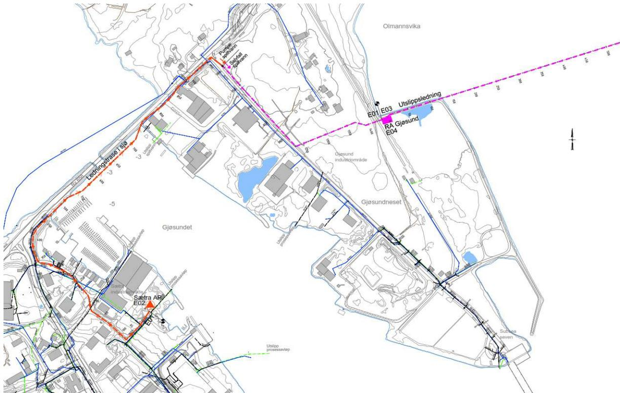
Figur 43: Planlagt overføring avløp frå utsleppssone 19 Gjøundsætra (Valderøya) til RA Gjø Sund og utslepp
