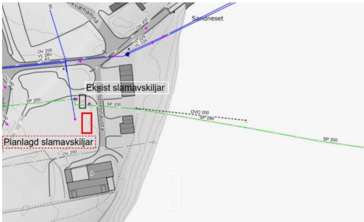
Figur 54: Eksisterande slamavskiljar 99 og planlagd utviding (200 m<sup>3</sup>) Valkvæ
